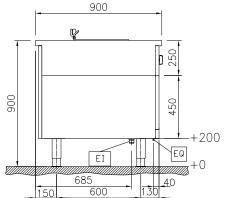
Electrical inlet (power) EQ Equipotential screw
